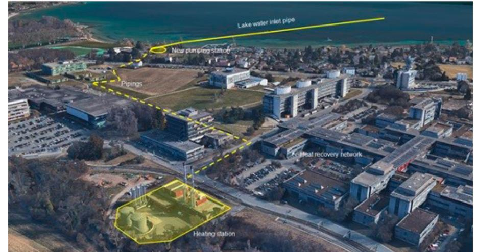
Centrale de chauffage et de refroidissement du campus UNIL-EPFL à partir de l'eau du lac Léman. Par la combinaison des besoins de chauffage et de refroidissement et la gestion de bassins tampons d'eau froide et d'eau réchauffée, ce projet permet d'augmenter considérablement l'efficacité globale du système (photo: Google Earth)
