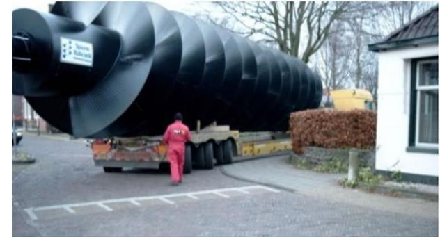
2 vis d'Archimède de 2.6 m de diamètre en série, chacun avec plus de 20 tonnes.
